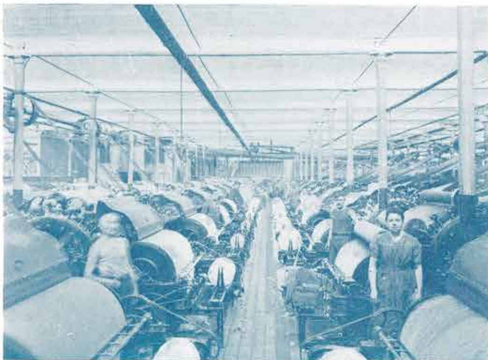
A gauche : Undes six assortiments de cardes. — A droite : Au premier plan, la préparation ; plus loin, un assortiment de peigneuses Lister.
