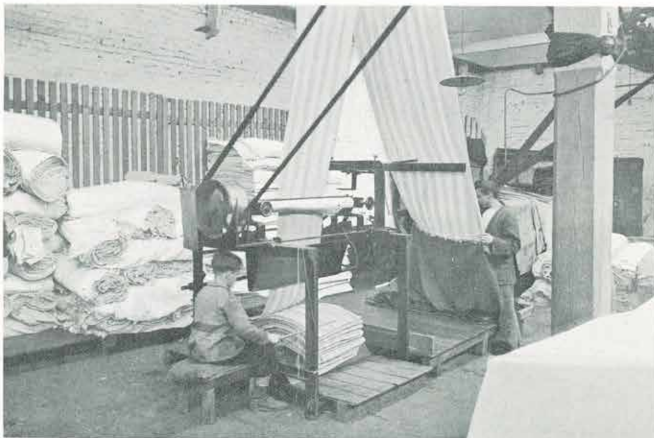
Les opérations de l'apprêt sont terminées, la pièce est « dossée » et pliée.
