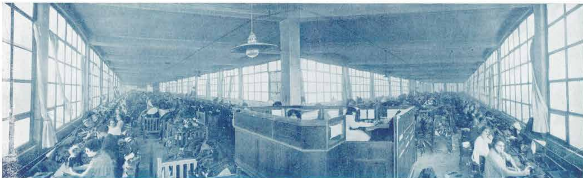
Un des ateliers des mécaniciennes. — Le banc de machines du côté gauche mesure 85 mètres de long ; il est actionné par un seul arbre de transmission.
