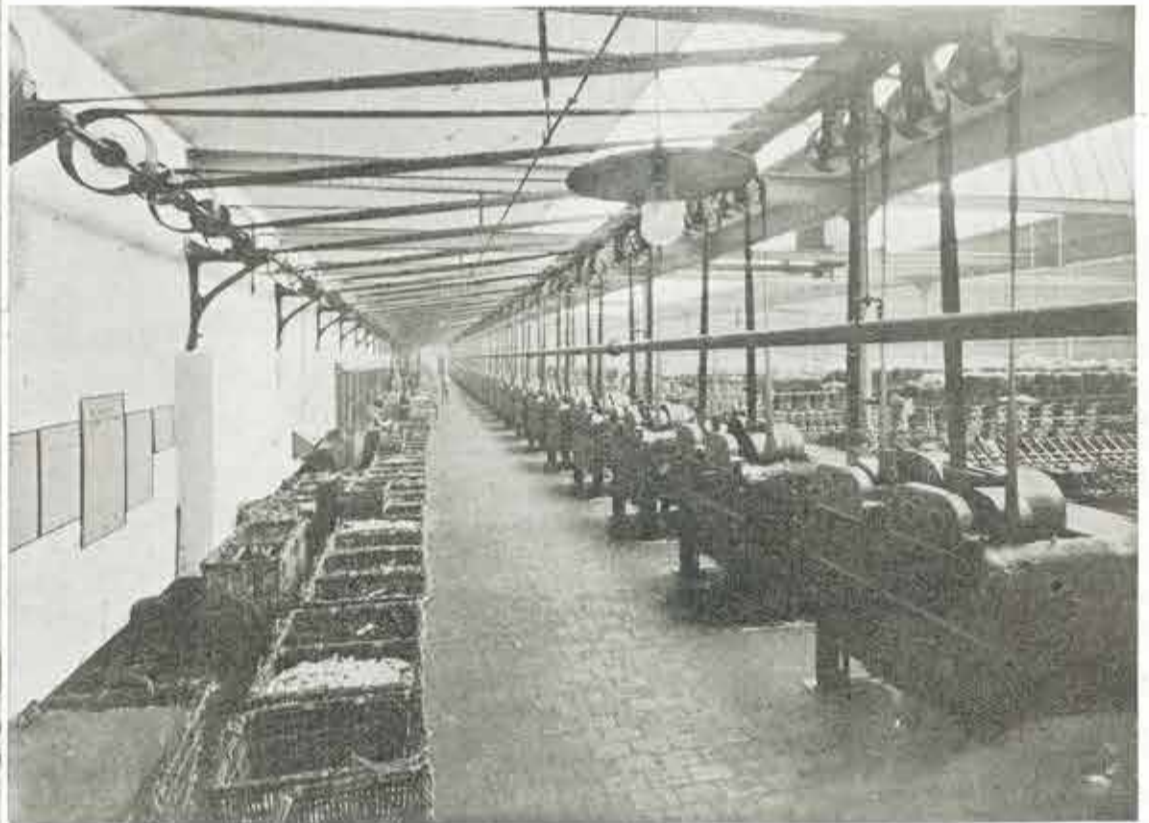
La salle des métiers continus qui comprend une imposante file de 64 métiers.
