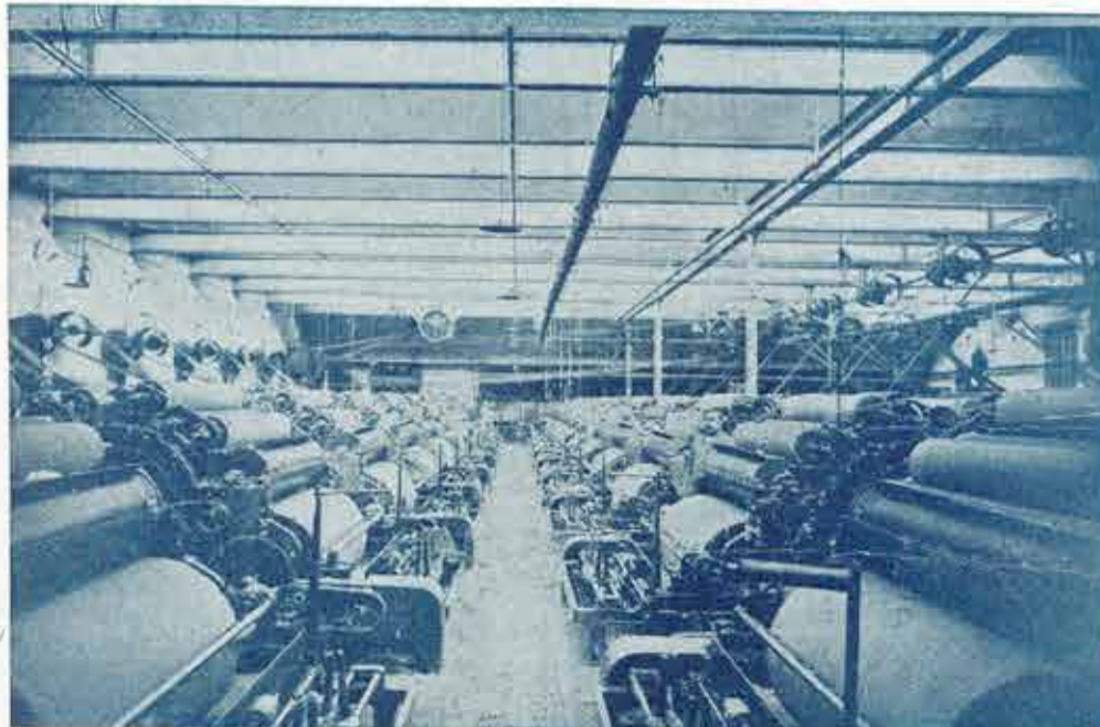
La laine lavée a ses fibres orientées, séparées les unes des autres et disposées de façon à former un boudin qu'on enroule en bobine.
