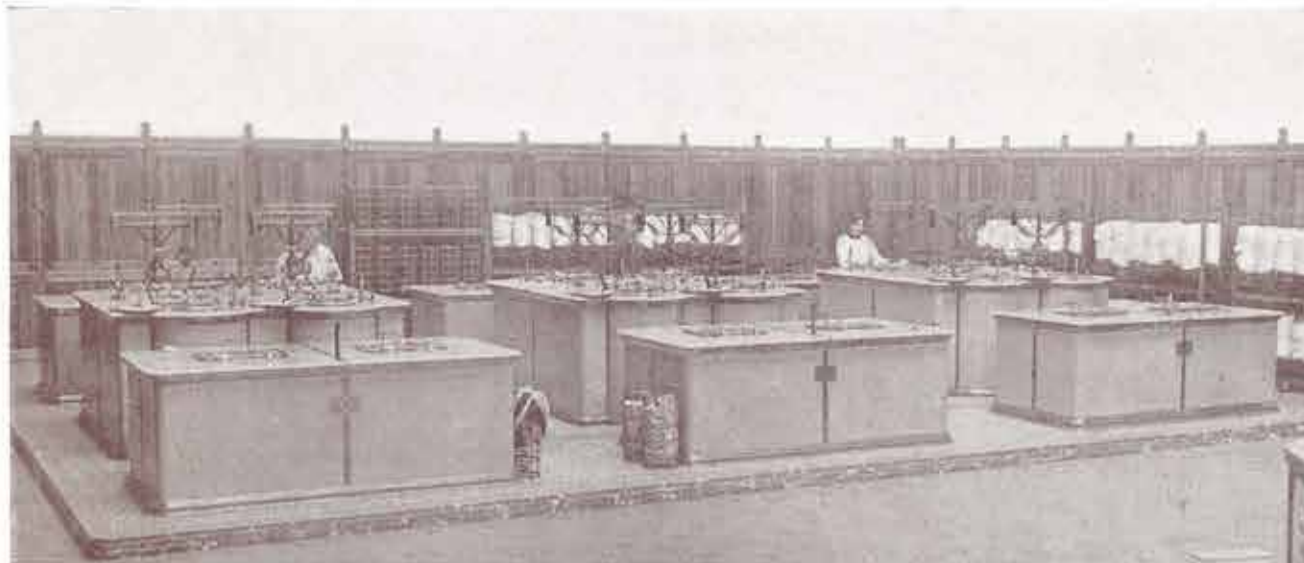
Conditionnement de Tourcoing : Groupe d'étuves municipales chauffées par la vapeur (Syst. A. Boule.)
