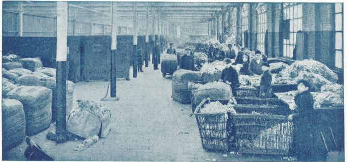
Triage des laines. — Chaque laine est séparée d'après sa finesse en 6 catégories environ.
